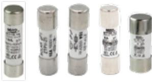
Protección contra sobrecarga y cortocircuito en líneas eléctricas (tipo gG), también disponible para la protección de piezas y equipos semiconductores contra cortocircuito (tipo Rs) y protección de motores (tipo aM). Tensión nominal hasta 660V; Corriente clasificada hasta 125A; Frecuencia de trabajo 50Hz AC; **Capacidad de ruptura nominal hasta 100KA**. Cumple con GB13539 y IEC269.
