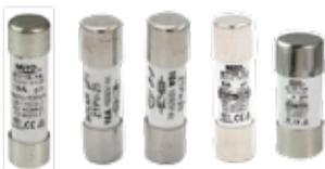
Protección contra sobrecarga y cortocircuito en líneas eléctricas (tipo gG), también disponible para la protección de piezas y equipos semiconductores contra cortocircuito (tipo Rs) y protección de motores (tipo aM). Tensión nominal hasta 660V; Corriente clasificada hasta 125A; Frecuencia de trabajo 50Hz AC; **Capacidad de ruptura nominal hasta 100KA**. Cumple con GB13539 y IEC269.
