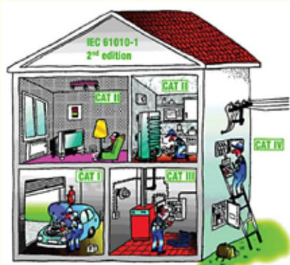
Categorías de Instrumentos de medición acorde a la norma IEC 61010-1 El estándar IEC 61010-1, cubre todos los aspectos de seguridad aplicables a instrumentos de medida, control y de uso en laboratorio. Trata aspectos de seguridad eléctrica, riesgo mecánico, térmico, inflamabilidad, radiación, etc.
